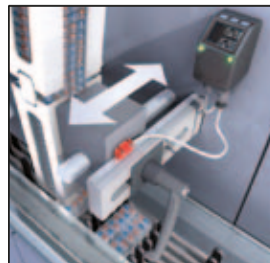
通过电子式位置指示器对滑块调节进行格式化调整
